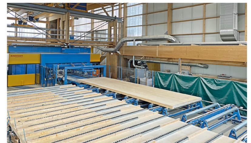
**Suite à leur taillage,** les éléments de CLT peuvent recevoir des finitions sur le convoyeur latéral
