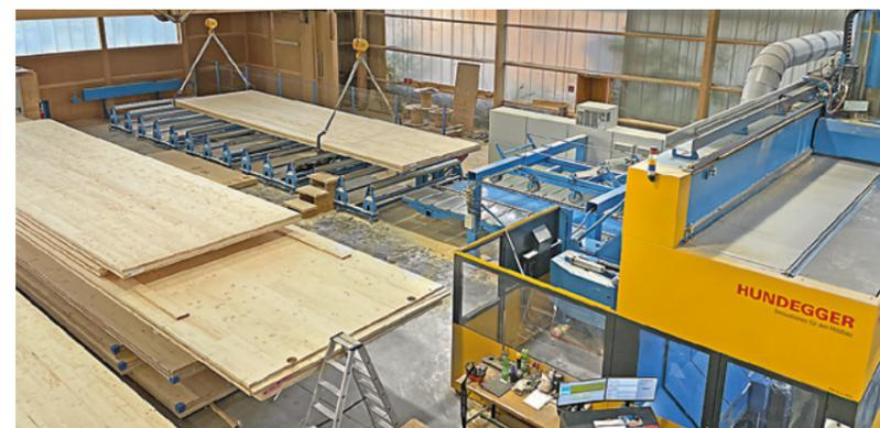
**Des éléments mesurant** jusqu'à 3,6 par 16,5 m par 40 cm d'épaisseur peuvent être travaillés sur le PBA-Drive
