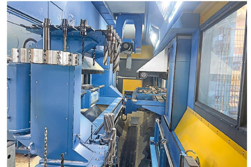
**Le changeur d'outils peut accueillir 26 outils.** En plus, la machine dispose d'outils spéciaux comme fraises à chaîne et deux agrégats de perçage à grande profondeur
