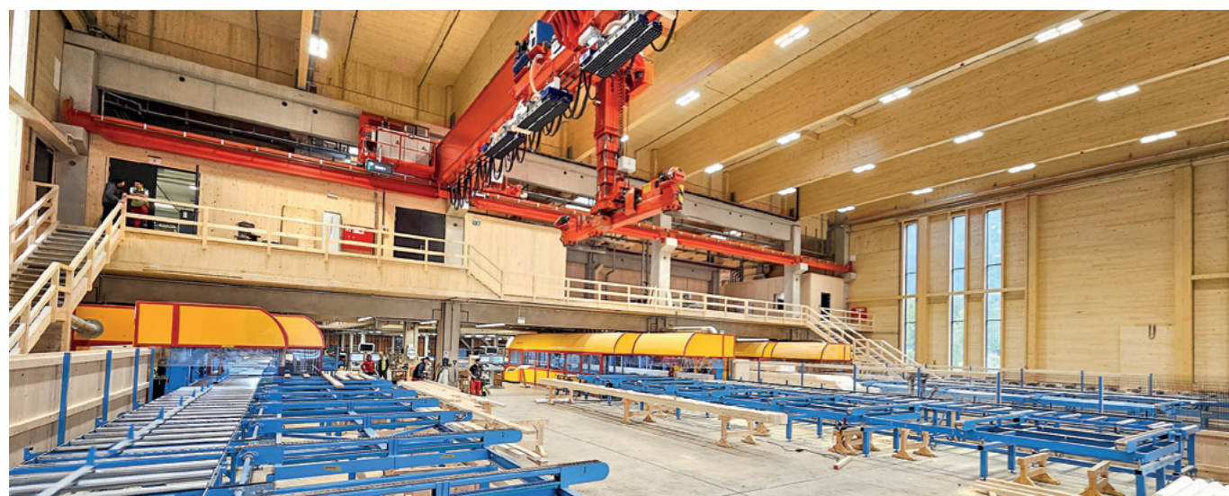
Un concentré de performances en matière de taille à Assling: à côté d'une K2i existante, Theurl vient d'installer deux K2-Industry de Hundegger pour lever sa production de taille de lamellé-collé au meilleur niveau technologique
