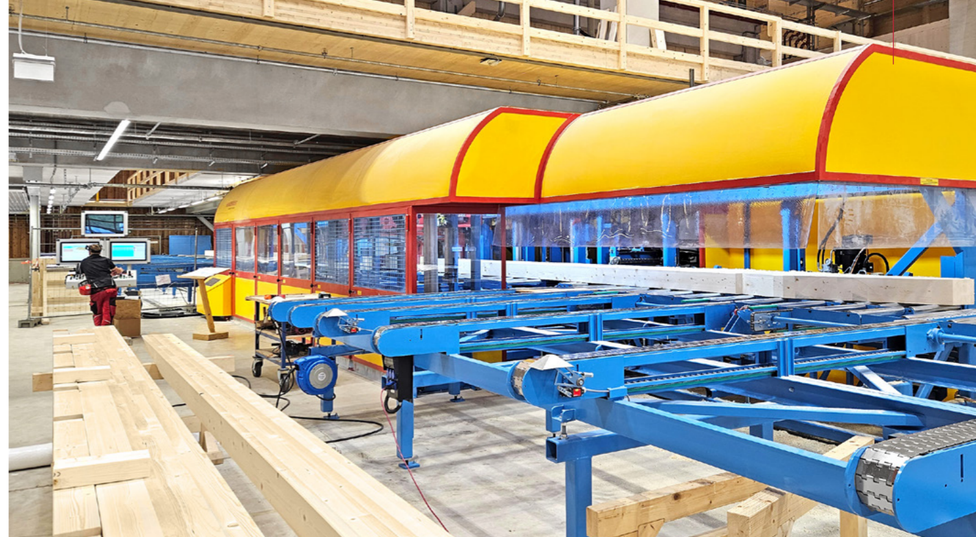
Chez Theurl les machines K2-Industry de Hundegger sont approvisionnées automatiquement pour servir selon leur capacité
