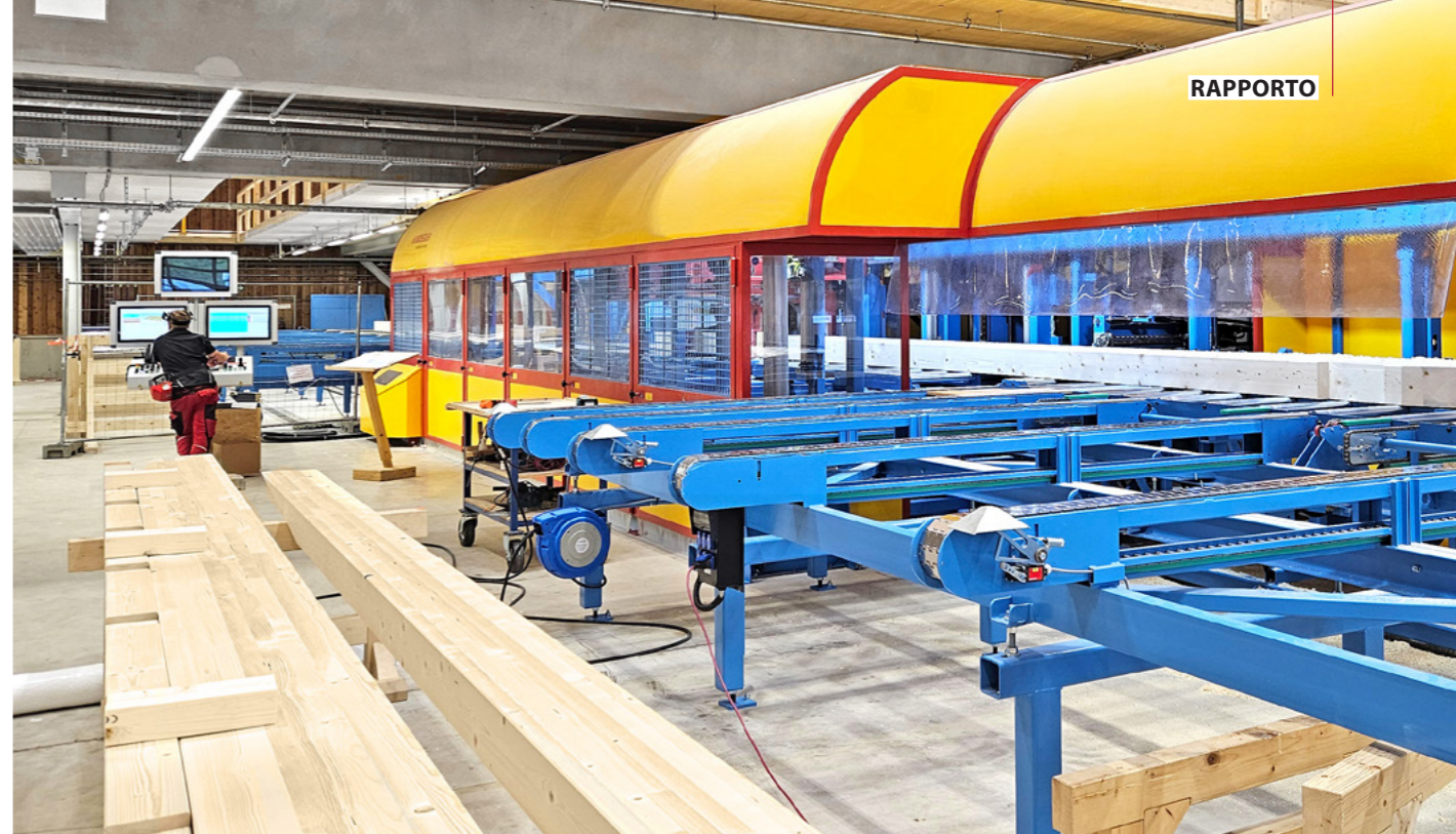
L'alimentazione automatica garantisce un ottimo livello di sfruttamento dei centri di taglio K2-Industry di Hundegger
