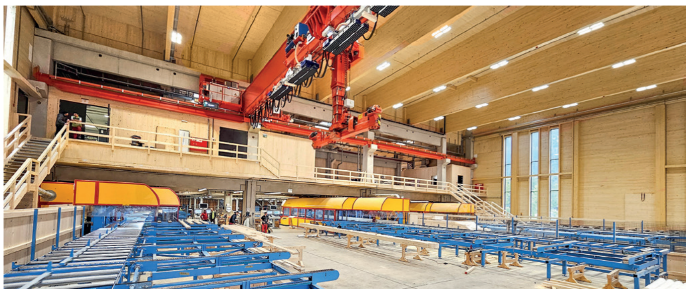
Performance concentrata ad Assling: Theurl ha incaricato Hundegger con il montaggio di due macchine di taglio K2-Industry accanto a un K2i esistente, portando all'avanguardia il proprio centro di taglio e lavorazione del legno lamellare
